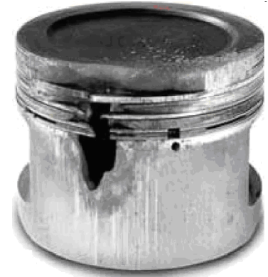
Şəkil 13.12. Detonasiyanın törətdiyi fəsadlardan nümunələr
