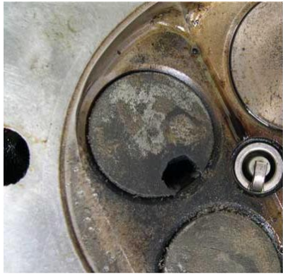
Şəkil 13.12. Detonasiyanın törətdiyi fəsadlardan nümunələr
