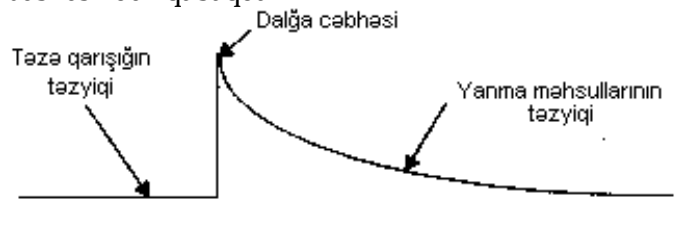
Şəkil 12.4. Detonasiya dalğasının inkişaf sxemi
