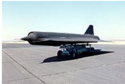
Şək.22.4. Pilotsuz kəşfiyyatçı Lockheed D-21B (ABŞ). Mərkəzi gövdəli oxa simmetrik giriş qurğulu DHRM.
