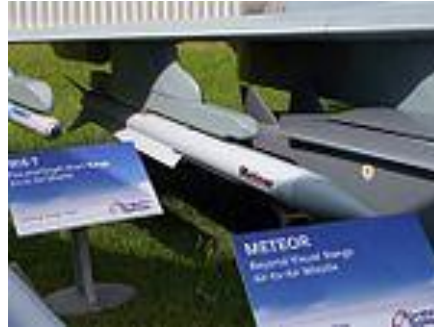
Şək.22.6. Ehtiyat DHRM-li qanadlı raket nümunəsi: "Meteor" (Avropa Birliyi) hava-hava raketi.
