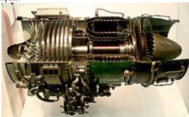
Şək.23.2. General Electric şirkətinin istehsalı olan J85 TRM.
