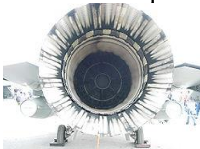
Şək.23.4. F-16 təyyarəsinin İTRMF F-100 tənzimlənən ucluğu, çıxış layları maksimal açılmışdır.
