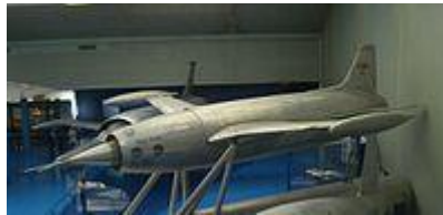
Şək.21.3. DHRM ilə uçan birinci aparat Leduc 010 (Le Burje Muzeyi) idi.
