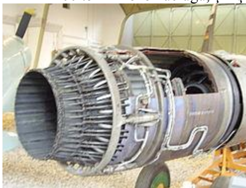
Şək.23.5. AL-21 tənzimlənən ucluğu, tənzimlənən çıxış layları maksimal bağlıdır.
