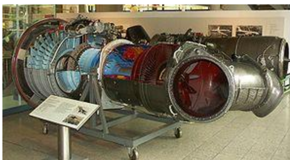
Şək.23.7. Şaquli qalxma və enməni yerinə yetirməyə imkan verən dönmə uçuqları olan Rolls-Royce Pegasus İTRM. Harrier təyyarəsində quraşdırılır.
