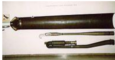
Şək.22.8. Klapansız U-şəkilli PHRM-nin nümunələri.
