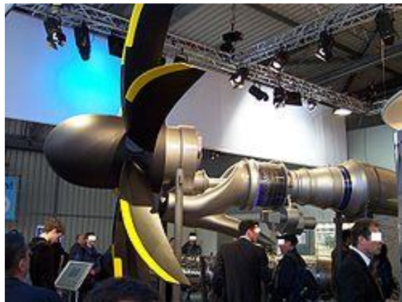
Şək.21.6. Turbovintli mühərrik. Vintin turbin valından olan intiqalı reduktor vasitəsi ilə yerinə yetirilir.
