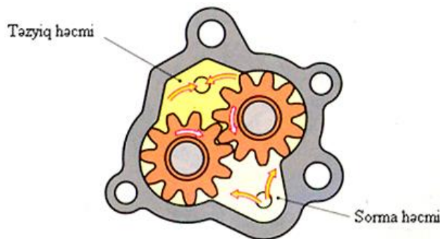
Şək.5.11. Dişli çarxlı yağ nasosu: a-sxemi; b-hissələri.
