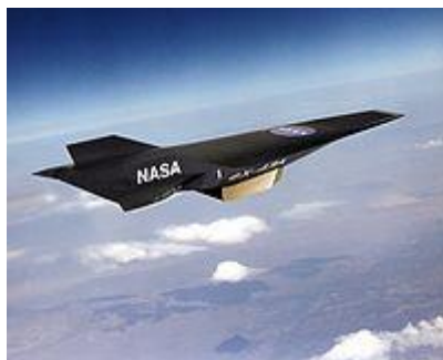
Şək.22.5. Hipersəsli eksperimental X-43 uçan aparatı.
