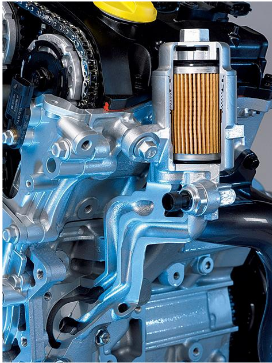
Şək.5.14. Lövəli-arakəsməli yağ süzgəcinin mühərrikdə quraşdırılması
