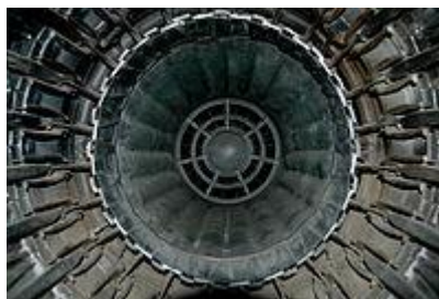
Şək.23.4. General Electric J79 TRM-nin forsaj kameri. Ucluq tərəfdən görünüş. Qurtaracaqda arxasında turbin görünən üstündə yanacaq injektorları quraşdırılan yanma stabilizatoru yerləşir.
