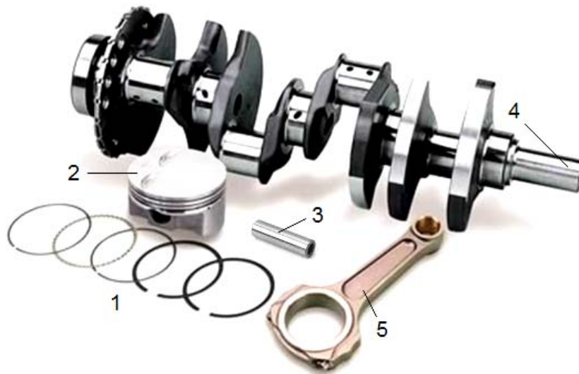
Şəkil 13. Çarxqolu-sürgüqolu mexanizminin tərpənən detalları:
