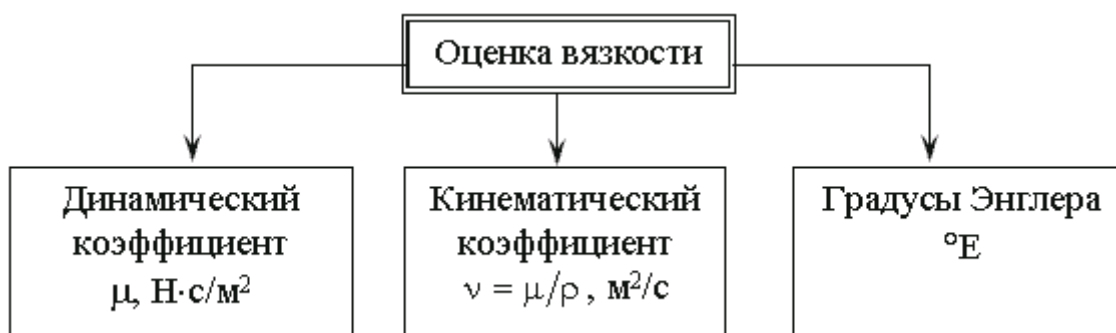
Рис. 1.8. Способы оценки вязкости жидкости
