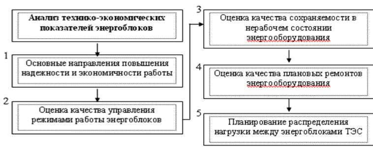
**Рисунок 16.** Блок схема алгоритма анализа ТЭП энергоблоков ТЭС.
