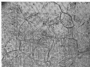
Şəkil 4. Almazla hamarlamadan əvvəl (a) və sonra (b) 10Г2С1 poladının üst qatının mikrostrukturunu (x800)
