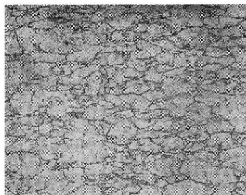
Şəkil 3. Almazla hamarlamadan əvvəl (a) və sonra (b) 12ГН2МΦАЮ poladının üst qatının mikrostrukturunu (x800)
