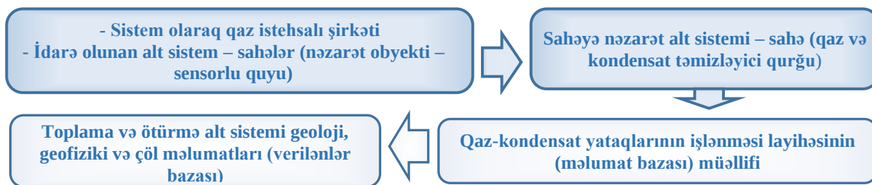
Şəkil 3. Qaz-kondensat yataqlarının işlənməsi üçün ikili dövrəli idarəetmənin sxemi
