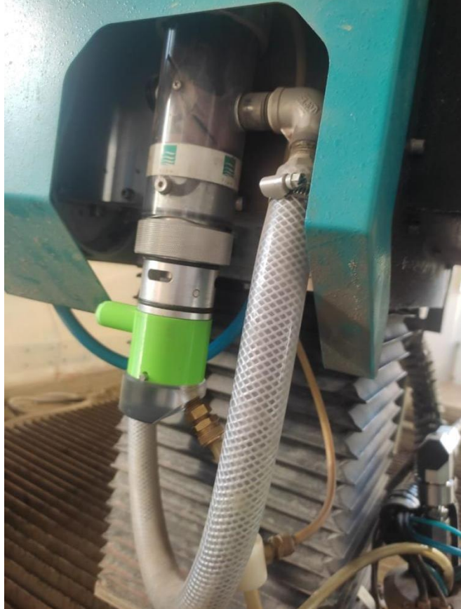
Şəkil 3.1.2 Hidroabraziv kəsmə dəzgahının su şırnağının təzyiqini tənzimləyən qurğunun ümumi görünüşü [9, s. 43]
