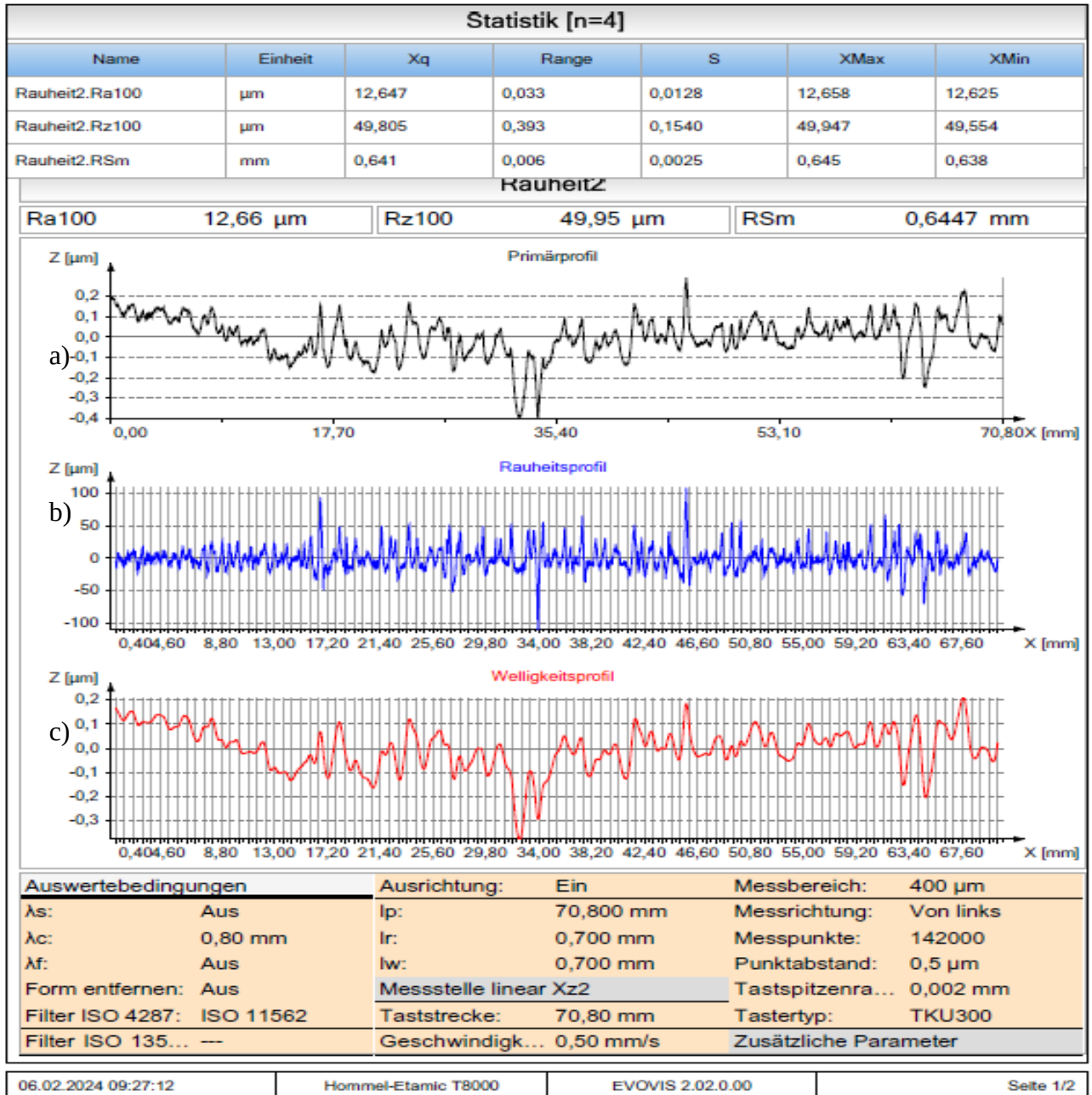
Şəkil 4.1.11 S_{uz} = 91 \text{ mm}/d_{eq} veriş sürəti ilə hidroabrazivlə kəsilmiş səthin sol kəşiyində profiloqram ölçüləri
