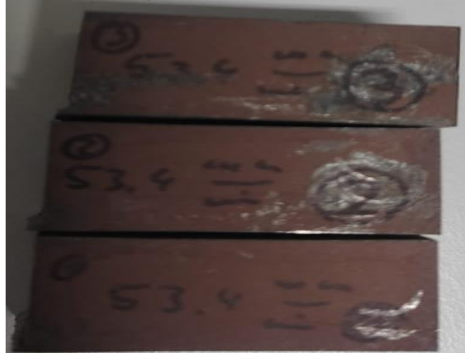
Şəkil 4.3.1 Ölçüləri 30 x 20 x 15 mm olan, HARDOX 500 materialından müxtəlif kəsmə sürətlərində ( S_{uz}=53,4 mm/dəq) hidroabraziv RPI dəzgahında emal olunan pəstahlar [4, s.440]
