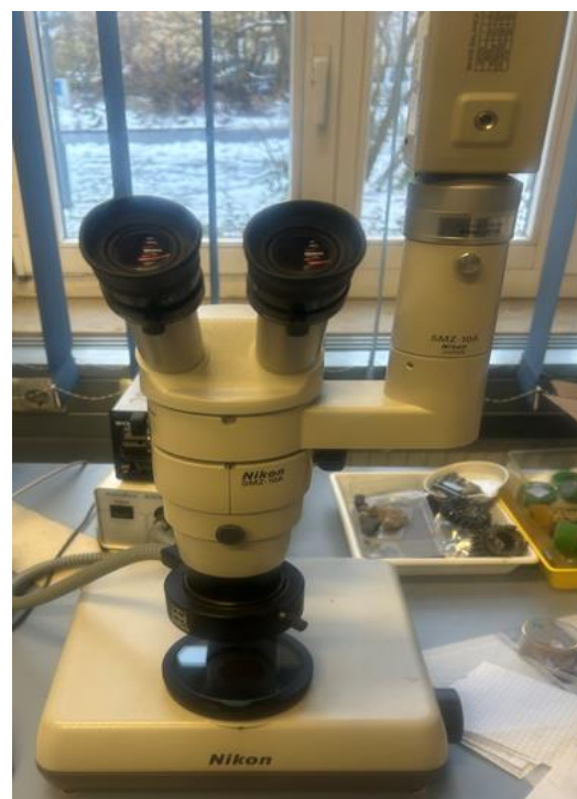
Şəkil 3.4.4 Nikon SMZ-10 modeli mikroskopun ümumi görünüşü [61, s.56]
