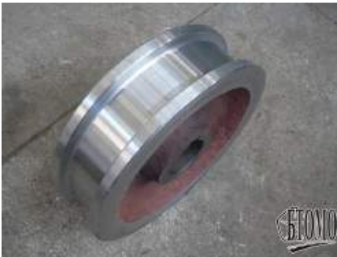
Şəkil 4.8. Körpülü kranın aparıcı təkəri.
