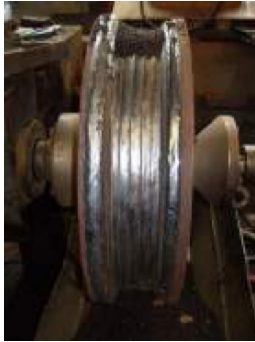
Şəkil 4.16. Kran təkərinin flüs qatı altında səthinin əridilib doldurulması.
