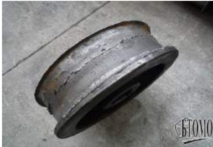
Şəkil 4.10. İstismarına icazə verilməyən qüsurlu kran təkəri.
