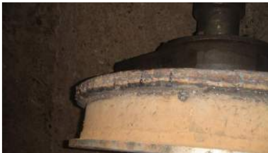
Şəkil 4.12. Elektrik qövsü ilə səthi əridilmiş rebordalı kran təkəri.
